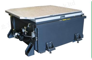
对于大型和笨重的负载,Team滑台具有非常强大的抗倾覆力矩,出色的负载能力,出色的横向振动控制,出色的动态刚度,出色的动态稳定性和阻尼。该系统由多个模块化T-Film轴承组装而成,具有2.5英寸(62.5毫米)的标准行程和12英寸(300毫米)的可用静态行程,可与所有现代长冲程振动台系统配合使用以创建理想的水平测试系统。该系统利用低压供油,实现零摩擦,零磨损,低维护特点。
