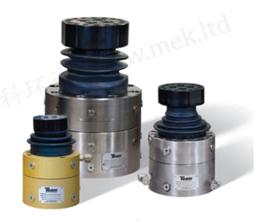
HydraBall 静压球头轴承,油支撑球窝接头,具有非接触表面。HydraBall在较小的封装中提供了非常坚固的连接,在3000psi(205Bar)的压力下仅需要0.2gpm(.75lpm)的油。没有高压密封垫,不会磨损或引起摩
