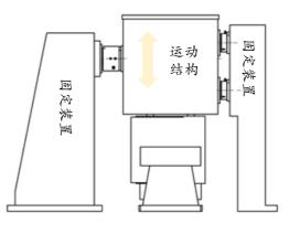
滑动轴承仅承受压缩载荷, 因此它必须与相对方向的轴承一起使用,以限制负载上的拉力和推力
