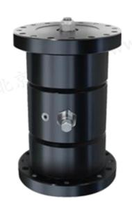
Hydrostatic Spherical Couplings 静液压球面联轴器在传递拉力和推力的同时允许角度未对准。这些联轴器在致动器和负载之间提供5个自由度,即垂直于致动器运动线的三个旋转自由度和两个平移自由度。 通过在执行器和工作台之间使用可以
