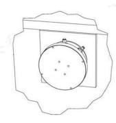
安装在运动结构上的 配套垫板的表面符合 一定的平整度和刚度 要求,以防止摩擦和 在载荷作用下变形。
