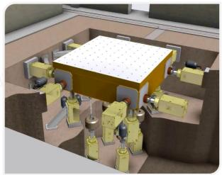
滑动垫静压轴承用于在振动测试期间引导和约束大型结构运动方向。这些独特的轴承在运动结构表面与固定装置之间形成了一个静液压油膜。滑动垫轴承可承受极高的载荷,正确布置,则一组滑动垫轴承的抗力矩能力高于
