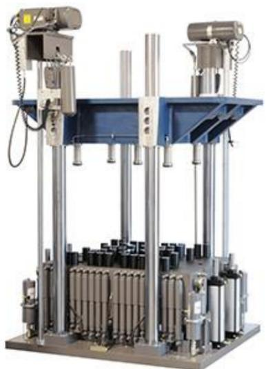
冲击测试可准确测量产品的易碎性，并评估产品如何响应特定的冲击输入。在确定您的产品是否能够承受其预期的运输和使用环境时，冲击测试数据是关键信息。对于任何机械冲击测试应用，Lansmont都有匹配的冲击测试系统来满足您的需求！
