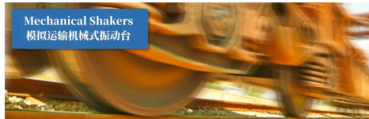
产品或包裹必须能抵抗在运输和使用环境中的各种冲击，碰撞和颠簸事件。机械振动台是一种低成本的测试设备，可以测试包装设计的完整性。Lansmont机械振动台根据ISTA, ASTM D999, TAPPI, ISO 2247, MIL-STD,
